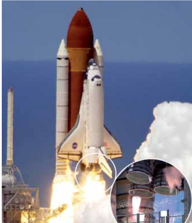
Ungeheure Kräfte beschleunigen das Raumschiff senkrecht in die Luft bis zu einer Geschwindigkeit von 28.000 km/h. Im kleinen Bild gut zu erkennen ist das Funksprühsystem, das austretenden Wasserstoff sofort verbrennt
